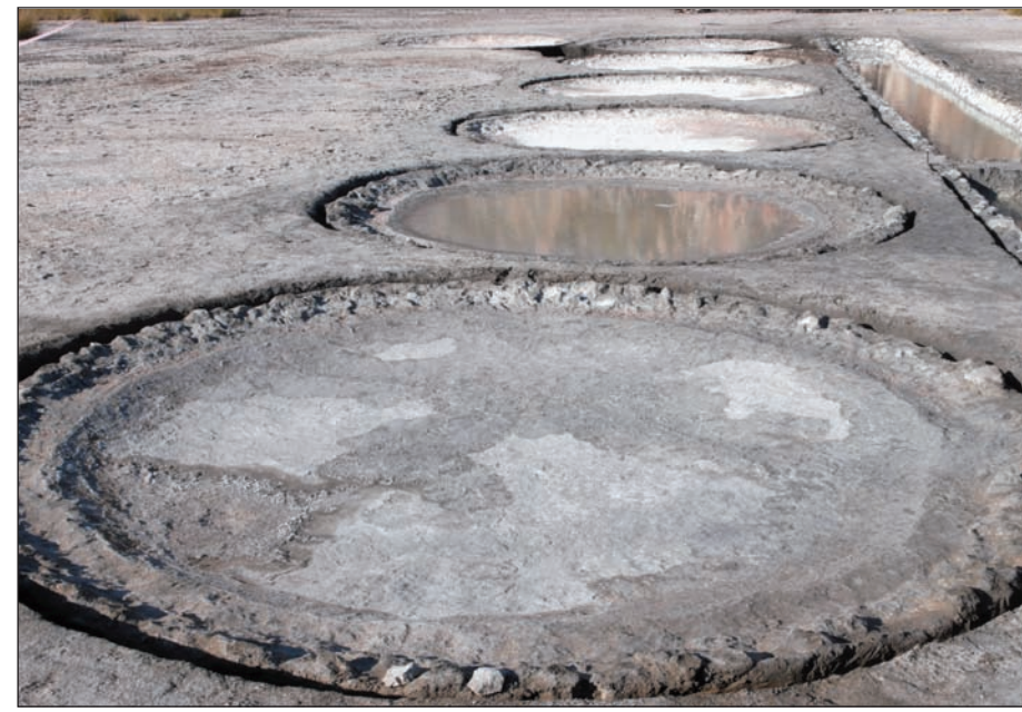
Tavanın tabanını kaplayan kristalleşmiş tuz (önde), tava içinde buharlaşmaya bırakılan deniz suyu (arkda)...
